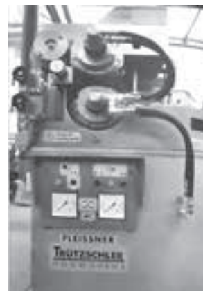
شکل ۲- دستگاه ایجاد جعد در الیاف با عرض کاری ۶۶۰ mm و ظرفیت ۲۲۵ تن در روز
